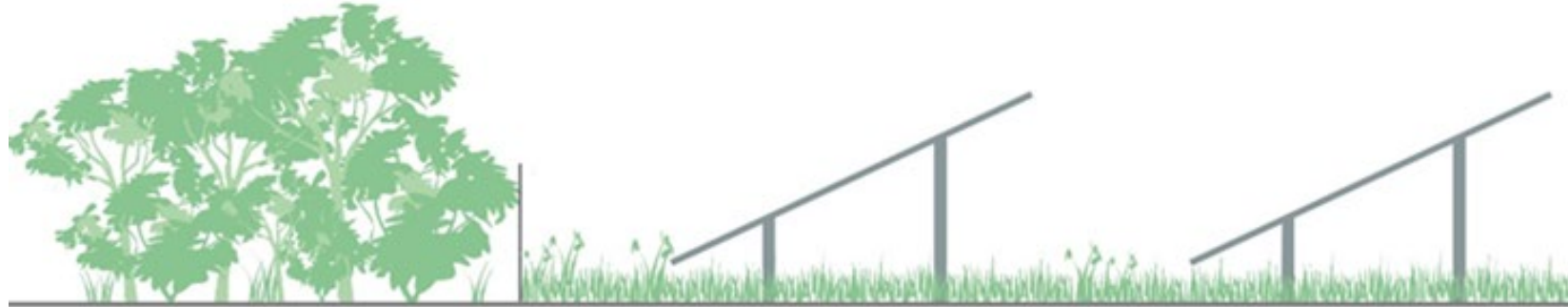
Paneler på tracker stativer – Princip for etablering af beplantningsbælte, vildthejn og solcelleanlæg
