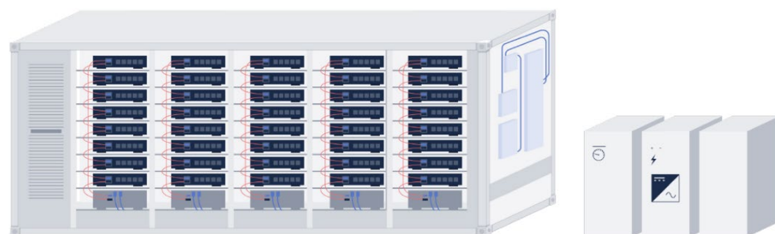
Illustration af battericontainer til venstre og teknikbygninger til højre.
